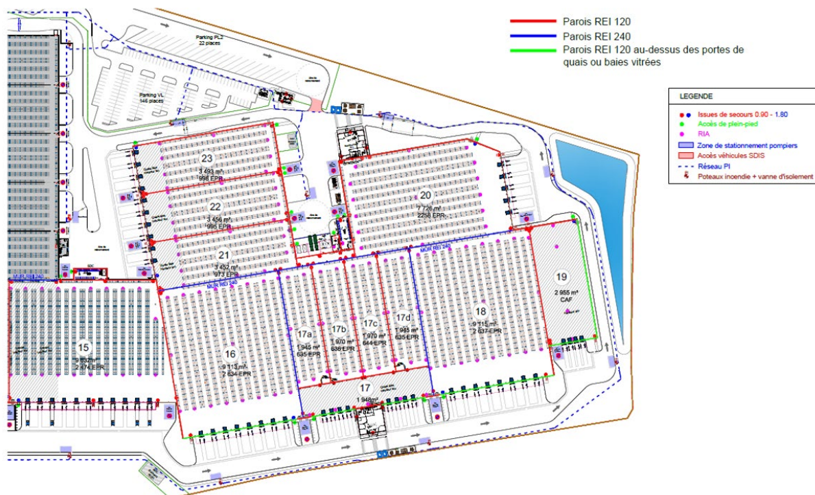
Figure 7: Degré coupe-feu des murs
